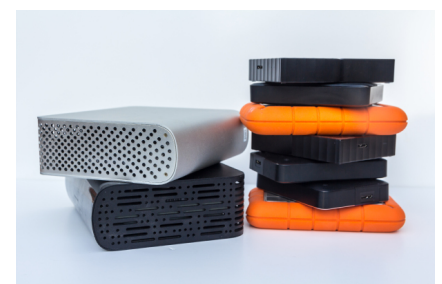
Figura 4. Carcasses de discos durs externs HD de 3.5" i 2.5".
