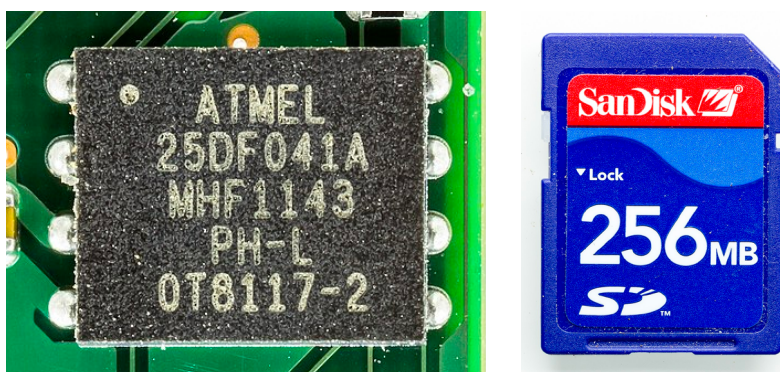
Figura 2. Memoria integrada en la placa base del dispositivo de tipo Flash y tarjeta SD de memoria Flash. Imágenes obtenidas de la Wikimedia con licencia libre de uso comercial: e.digitall.org.es/wikimedia-memoria y e.digitall.org.es/wikimedia-tarjeta-SD .
