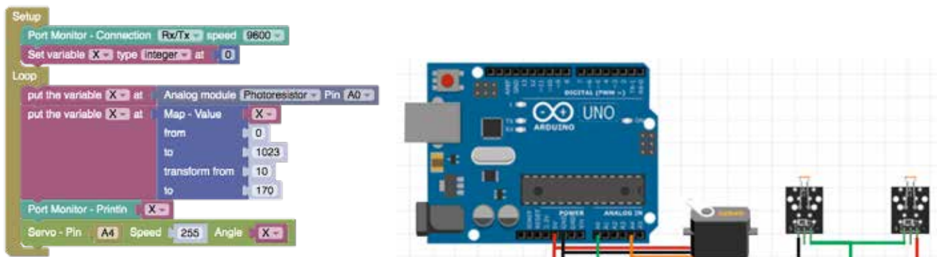
1. irudia: ArduBlock-eko proiektu baten adibidea, eguzkiaren ibilbideari jarraitzen dion serbomotorra bat bi fotorresistore erabiliz kudeatzeko. Iturria: ardublock.ru
